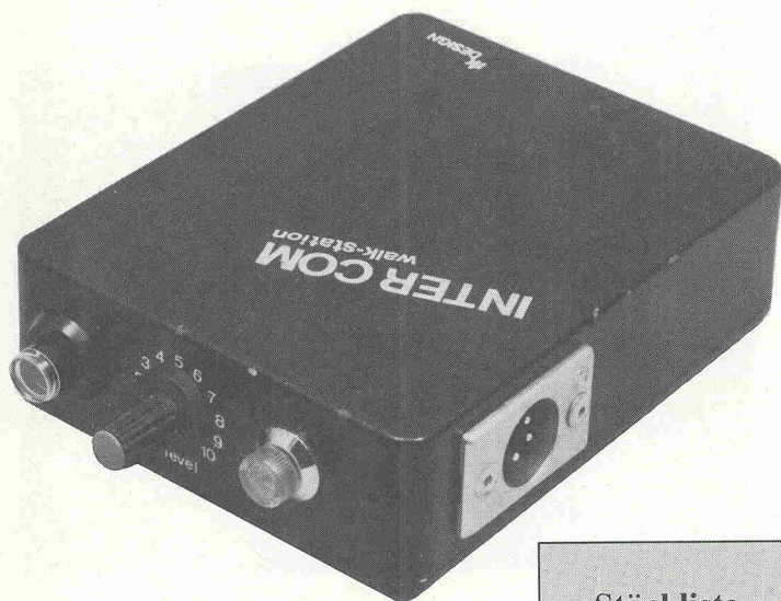
Bild 5. Alle ans Intercom angeschlossenen Stationen werden über ein symmetrisches Mikrofonkabel miteinander verbunden. Das kleine Gehäuse kann man sich an den Gürtel oder sonstwohin stecken (Jackentasche, Mischpult oder Kamerastativ).
